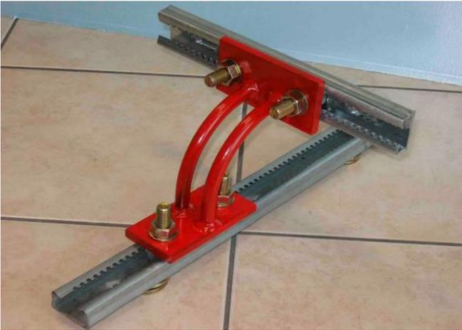
la plasticizzazione degli elementi curvilinei garantisce la possibilità di sviluppare elevate deformazioni tra gli elementi collegati, limitando allo stesso tempo l'azione trasmessa dal tegolo alla trave in caso di un evento sismico
